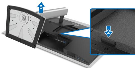
Чтобы снять стойку, выполните следующие действия:
