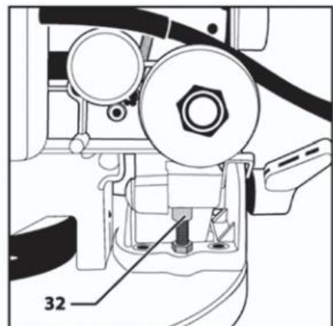
По достижении необходимого результата регулировки ослабьте установочный винт указателя угла наклона, совместите стрелку указателя с делением 0° на шкале угла наклона. Зафиксируйте указатель винтом.
