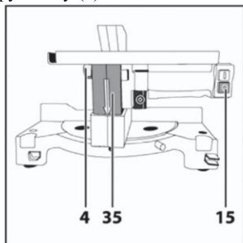
**ПРИМЕЧАНИЕ:** Инструмент автоматически переключает выключатели с (1) на (15) и обратно при переводе пилы из одного режима в другой.
